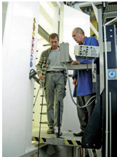
Hubtisch mit Verlängerung für Nachbeschichtung in Kabinenöffnung
